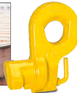
TCU containerkrog Bæreevne: 32 – 40 ton ved 4 stk. Monteres på siden af container i top eller bund
