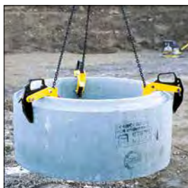
BTG Rørophæng Bæreevne: 1.500 – 3.000 kg Gab: 40-120 / 50-180 / 90-220 mm For løft af brøndring DIN 4034
