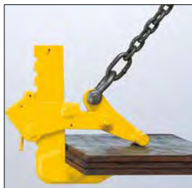
TGF Klo for løft af plader i pakker Bæreevne: 0,35 – 6,6 ton Anvendes parvis
