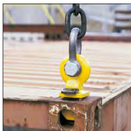
TCO containerkrog Bæreevne: 56 ton ved 4 stk. For vertikalt løft i toppen af container Anvendes i forbindelse med løfteåg
