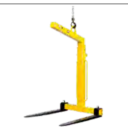
TKG vhs og TKG vha. pallegaffel Bæreevne: 1.000 – 5.000 kg Indstillelig gaffelbredde og højde Automatisk balancesystem så gafflerne altid peger opad
