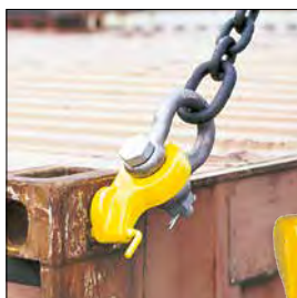
TCU containerkrog Bæreevne: 32 – 40 ton ved 4 stk. Monteres på siden af container i top eller bund
